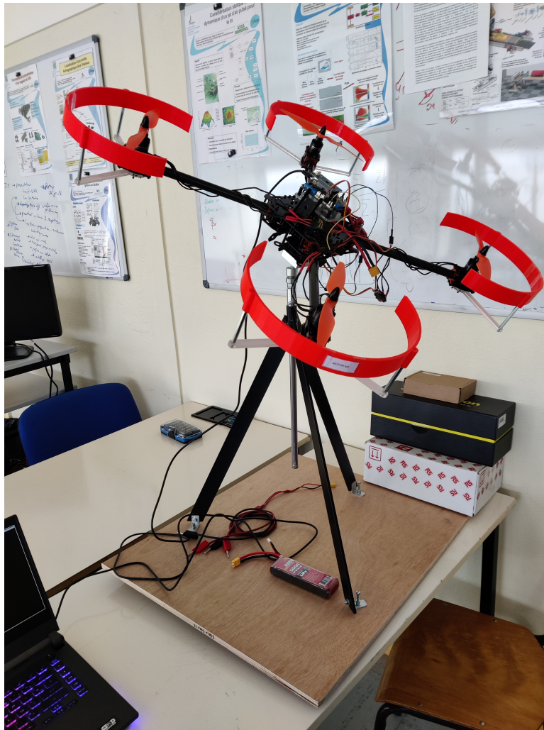
Figure 3.12 – Banc d'essai à 4 degrés de liberté pour quadricoptère
