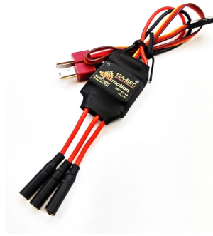
Figure 3.5 – Contrôleur électronique de vitesse (Lynxmotion 12A ESC SimonK)
