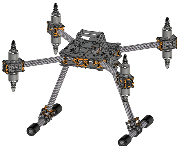
Figure 3.2 – Cadre du quadricoptère (Lynxmotion Multirotor Erector Set)
